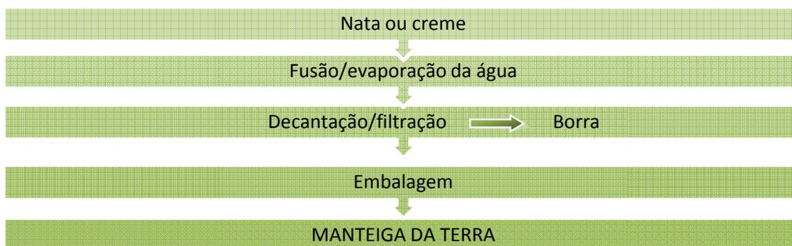
**Figura 24: Fluxograma de processamento de manteiga da terra.**
