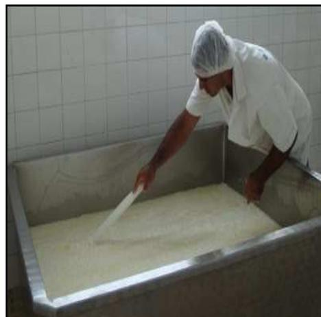
**Figura 22: Filagem da massa do queijo de coalho- Cachoeirinha/PE**
